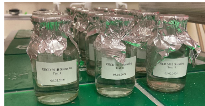
Abb. 3: Modifizierter Screening-Ansatz zur Untersuchung des Bioabbaus in Klärschlamm in Anlehnung an OECD 301B Richtlinie.
